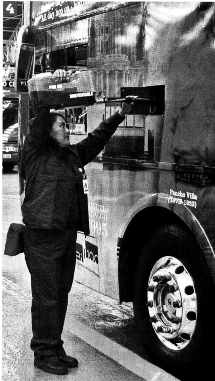
> Los 3 camiones que usan el biocombustible se abastecen en la terminal de la TAPQ. El 20% es biodiesel y el resto diesel normal.
