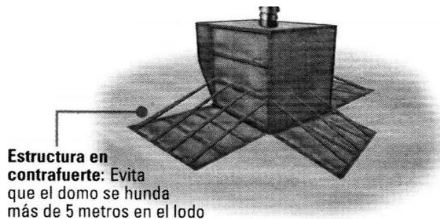
**Estructura en contrafuerte:** Evita que el domo se hunda más de 5 metros en el lodo
